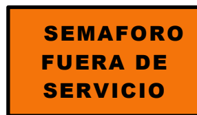
Figura 5.503- 11 Semáforo Fuera de Servicio (ITO-3)
