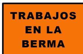
Figura 5.503- 24 Trabajos en la Berma(ITO-13)
