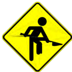
Figura 5.503- 01 Trabajos en la vía (PT-1a)
