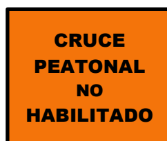
Figura 5.503- 12 Cruce Peatonal Cerrado (ITO-4)
