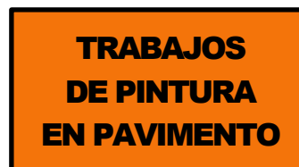
Figura 5.503- 28 Trabajos de Pintura en Pavimentos (ITO-17)
