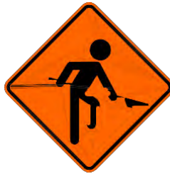
Figura 5.503- 02 Trabajos en la vía (PT-1b)
