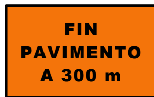
Figura 5.503- 20 Fin Pavimento (ITO-9)
